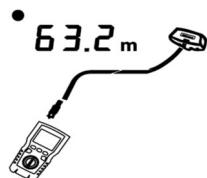
Obrázok 6.14 Výsledky merania koaxiálneho kábla
