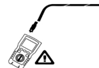
Obrázok 6.17 Napätie na koaxiálnom kábli
