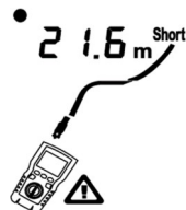
Obrázok 6.16 Skrat na koaxiálnom kábli
