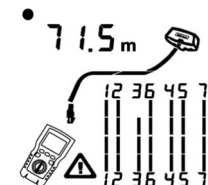
Obrázok 6.2 Odpojenie na krútenom sieťovom dvojvodiči
