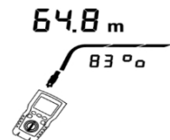
Obrázok 9.2 Stanovenie skutočnej hodnoty NVP kábla
