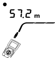
Rysunek 6.15 Otwarty obwód na okablowaniu koncentrycznym
