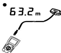
Rysunek 6.14 Wyniki pomiarów dla kabla koncentrycznego
