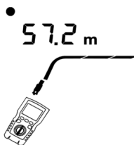
Figura 6.15 Aperto sul cablaggio coassiale
