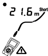
Figura 6.16 Corto sul cablaggio coassiale
