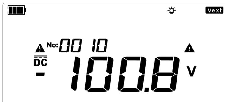
Figura 9.24 Misura della tensione CC negativa
