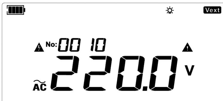
Figura 9.23 Misura della tensione CA
