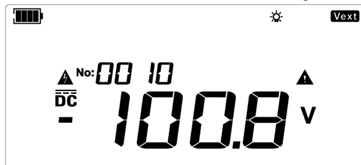
Figure 9.24 Mesure de la tension DC négative
