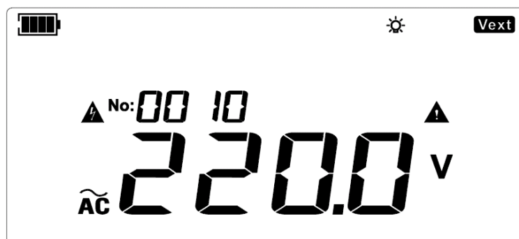
Obrázek 9.23 Měření střídavého napětí
