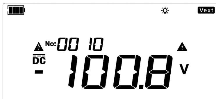
Obrázek 9.24 Měření záporného stejnosměrného napětí
