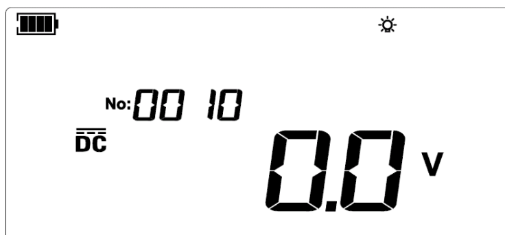
Obrázek 9.21 Měření střídavého/stejnoseměrného napětí (výchozí rozhraní)
