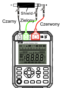
Rys. 10.1.2 Połączenie trójprzewodowe
