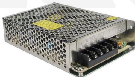
Jedná se o základní řadu elektronicky spínaných zdrojů vhodných pro LED svítidla. Ze zdroje nevedou žádné kabely. Je potřeba do něj zapojit kabel ze sítě s 230V. Z tohoto kabelu jsou vyvedeny další 3, je to zelený (zemníci), modrý (N) a hnědý (L). Dále jsou zde zdírky + (červený) a - (černý). Kabely z pásku takto zapojíme. Pozor! Před zapojením se ujistěte, že ze sítě nejde do zdroje napětí! Pokud si nejste zapojením jisti, svěřte jej autorizované osobě.
