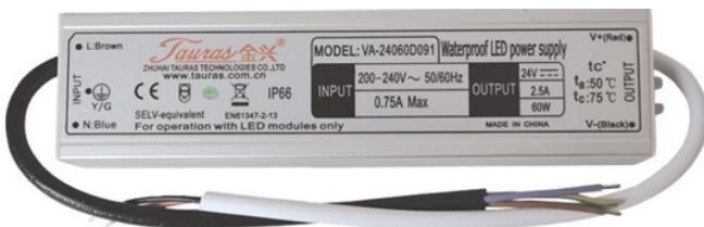
Tyto zdroje splňují krytí IP66 (odolnost proti vodě a prachu). Jsou z nich již vyvedené kabely. Ty je však potřeba dále připojit do sítě a do LED pásku. Doporučujeme použít svorkovnici nebo kabely spájet k sobě. Pokud to však situace vyžaduje, je třeba spoje dobře utěsnit. Zde můžeme znova použít smršťovací bužírku a oba konce ještě utěsnit silikonem.
