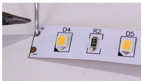
Pokud chcete pájet LED pásek s krytím, je nejprve nutné odstranit krycí gel (návod níže). Po napájení je pro zachování krytí nutné pásek utěsnit, většinou se k tomu využívá bužírka, která se po zahřátí smrští (smršťovací bužírka).
