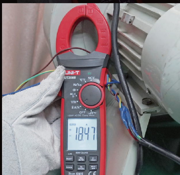
Zachycení přechodového proudu (UT206B / 207B / 208B)
