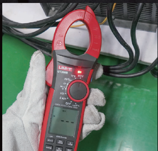
Vícesegmentový displej NCV a zvukový / vizuální alarm
